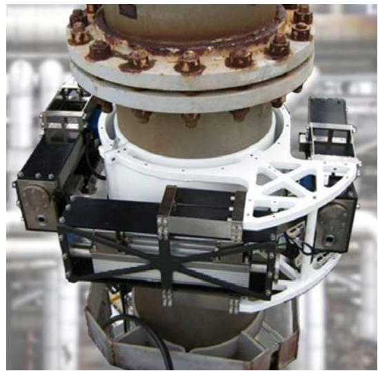
ADDPipe im Einsatz (ohne Einhausung)
