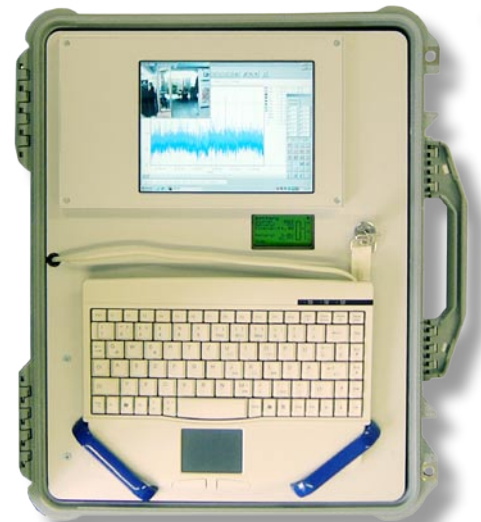
NOISY-Monitor in der Premium-Version als „intelligente“ Außenstelle zur Messung von Lärm, Meteorologie mit Anschluss von - bis zu - 12 weiteren Umweltsensoren
