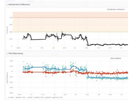
Softwareoberfläche zur Analyse und Auswertung der Messdaten
