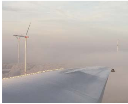
Rotorblattspitze mit Vereisung, durch die eine Unwucht verursacht wird
